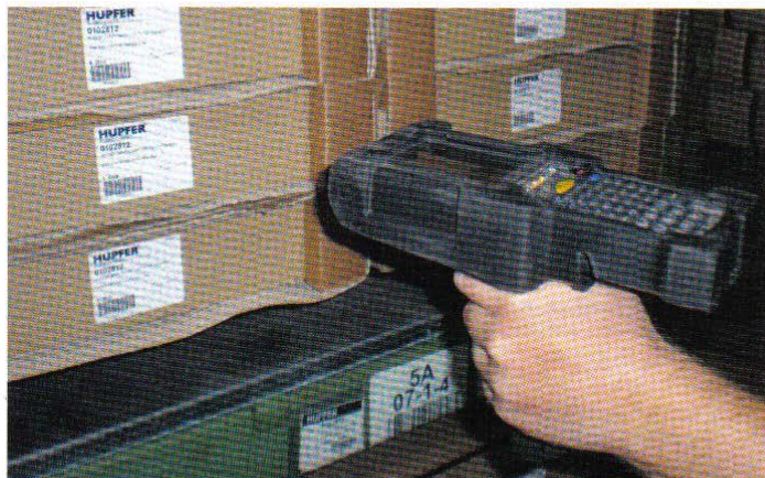
Der zweiten Schritt: die Einführung der beleglosen Abwicklung durch WLAN-Datenfunk und Handdaten-terminals im Wareneingang.
